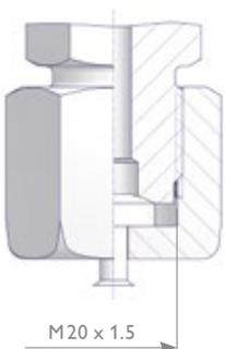
Test Flange  $\varnothing 40 \times 5$
